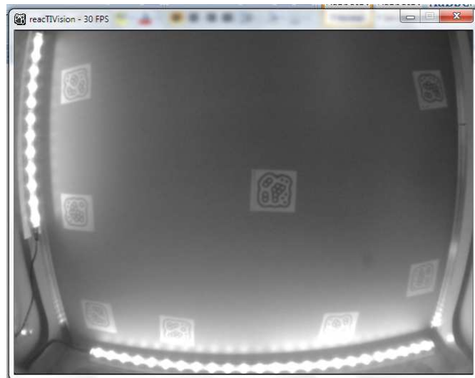
Figura 4.14 - Imagen tomada por la cámara con leds colocados en los laterales de la mesa
