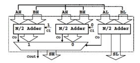
Dados dos sumandos A y B de N bits se los divide en dos partes: una parte (AL y BL) compuesta por los N/2 bits menos significativos, y una parte (AH y BH) compuesta por los N/2 bits más significativos restantes. Para la suma AL+BL se usa un único sumador "L" de N/2 bits, en tanto que para la suma de AH+BH se emplean dos sumadores, H0 y H1: H0 con Cin=0, y H1 con Cin=1, usándose luego la señal de salida Cout del sumador "L" para optar entre las salidas de los dos sumadores Hi.
