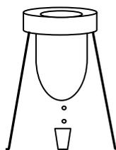
Filtro modelo Condorhuasi, diseño cilíndrico, de base ovalada y con aletas en la parte superior para su colocación en un soporte metálico o de madera con pies.
