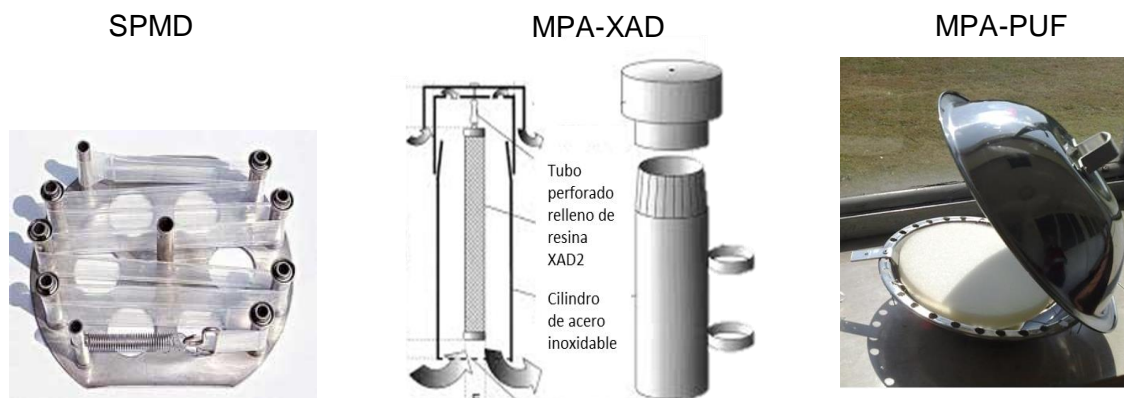
Figura 9. Muestreadores pasivos de aire: membranas semipermeables rellenos de trioleína (SPMD), resinas XAD y disco de espuma de poliuretano.
