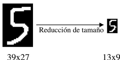
Figura 6: Reducción de tamaño de la imagen ensanchada
