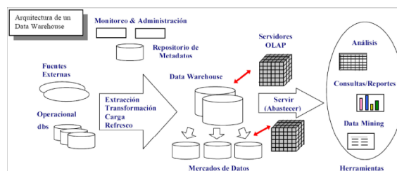
Figura 1: Arquitectura de un Data Warehouse.
