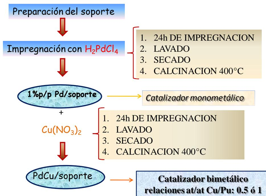
Figura III-11. Esquema de preparación de catalizadores Pd y PdCu
