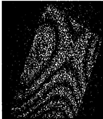
*Figura 4.7 Franjas de correlación producidas por sustracción.*
