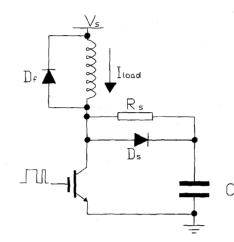
Fig. 1. The RCD snubber.
