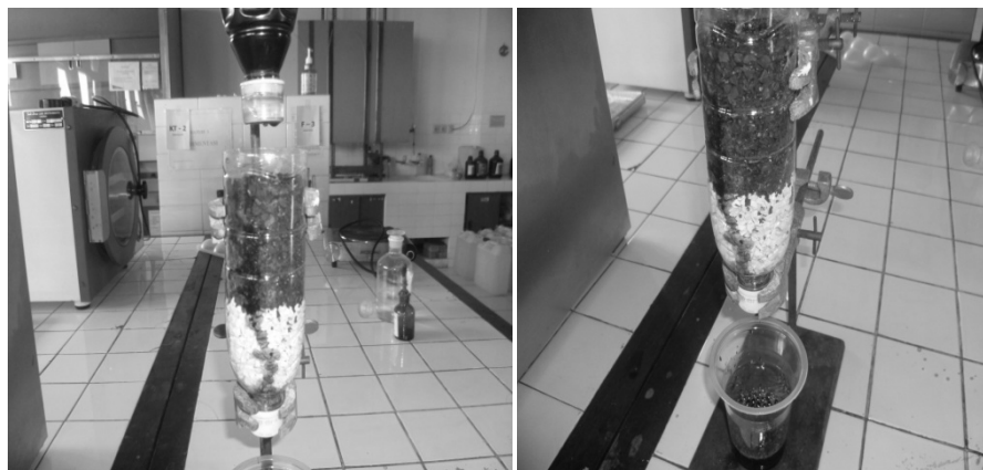
Gambar 5. Penjernihan Asap Cair dengan Kolom Arang Aktif
