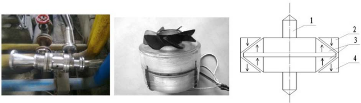
图 5：实验中的永磁悬浮涡轮机（左），它的实验模型（中）和原理图（右） [15]
