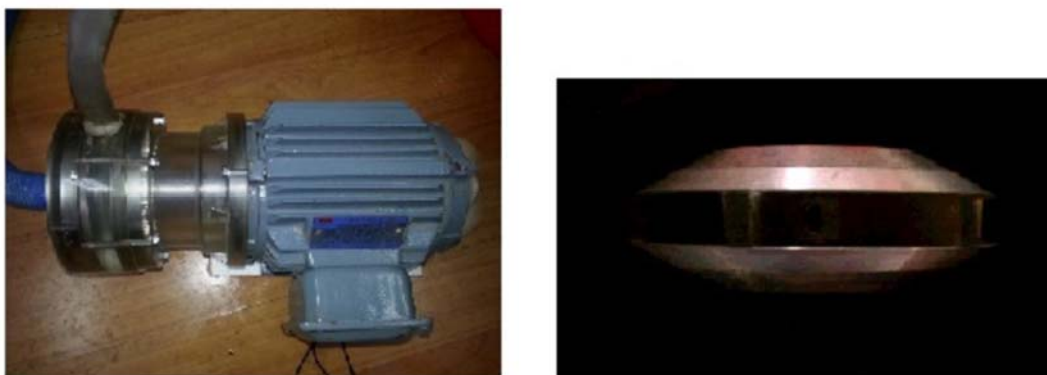
图8：工业上使用永磁悬浮离心泵（左）和它的叶轮（右）
