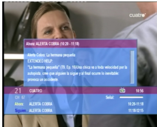
Figura 99. Barra de navegación del receptor Sanyo TU-D935 que no incluye señalización de subtítulo.
