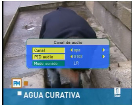
Figura 96. Menú de activación del audio alternativo en el receptor Supratech TDT Vision Icaro.
