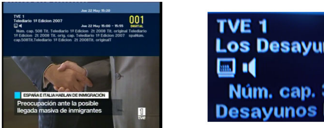
Figura 136. Barra de navegación del receptor Sony Bravia y detalle de los iconos de señalización del subtítulado y el audio alternativo.
