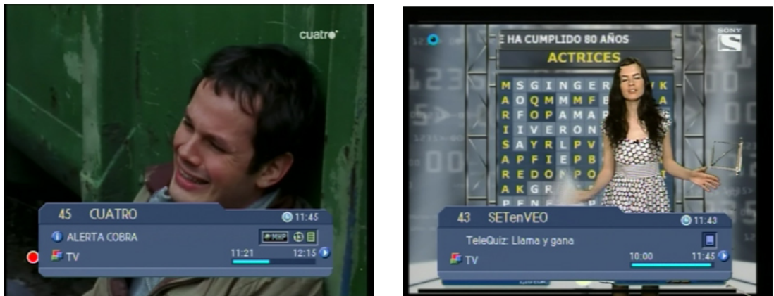
Figura 160. Barra de navegación del receptor MHP Humax DTT 4100 donde se presentan los iconos de subtítulo y teletexto.
