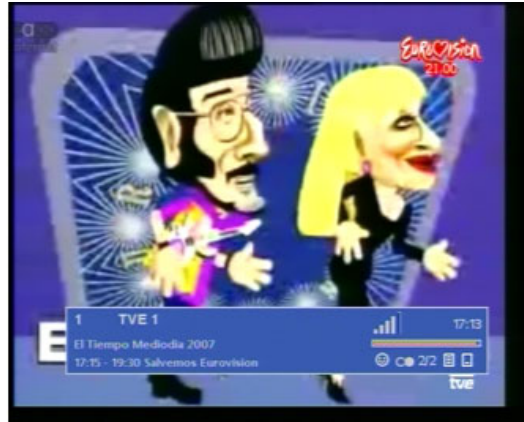
Figura 74. Barra de navegación del receptor Siemens Gigaset M360 donde se presenta información de subtítulo e idioma de audio.
