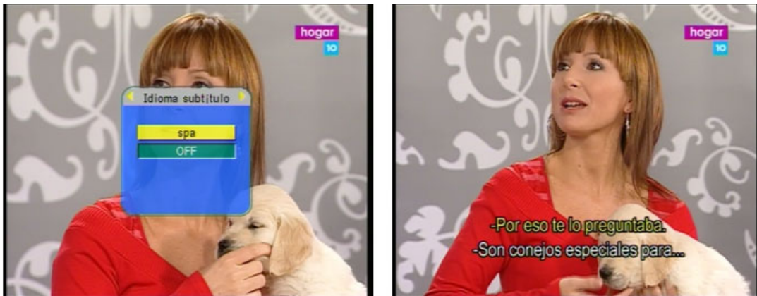
Figura 92. Selección de idioma para los subtítulos DVB en el receptor Supratech TDT Vision Icaro.
