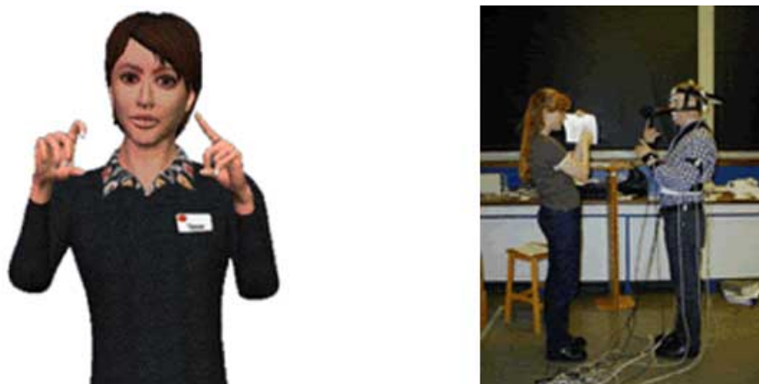
Figura 35. Tessa (izquierda), el ‘avatar’ intérprete de la lengua de signos, y el proceso de captura de movimientos para la generación de los gráficos 3D (derecha).
