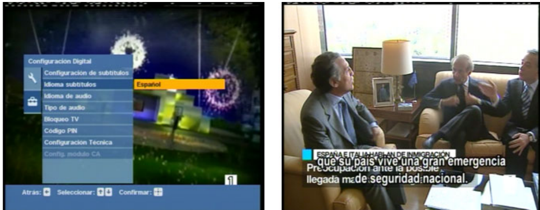
Figura 138. Menú de selección de idioma del subtítulo en el receptor Sony Bravia e imagen de subtítulo DVB.
