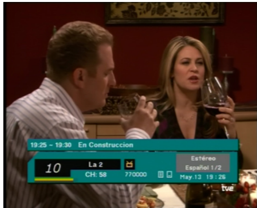
Figura 128. Barra de navegación del receptor Drake ESR T122 donde se presentan los iconos de subtítulo y teletexto.
