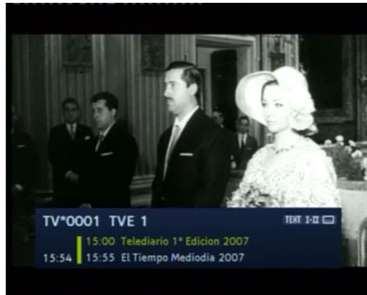
Figura 118. Barra de navegación del receptor Philips DTR 210 donde se presenta información de subtítulo e idioma de audio.
