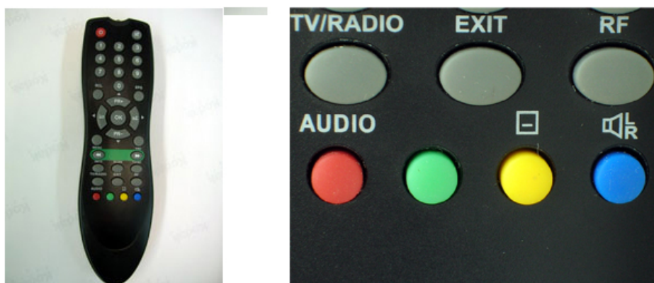
Figura 129. Detalle de los botones de activación del subtítulo y audio alternativo en el mando del receptor Drake ESR T122.
