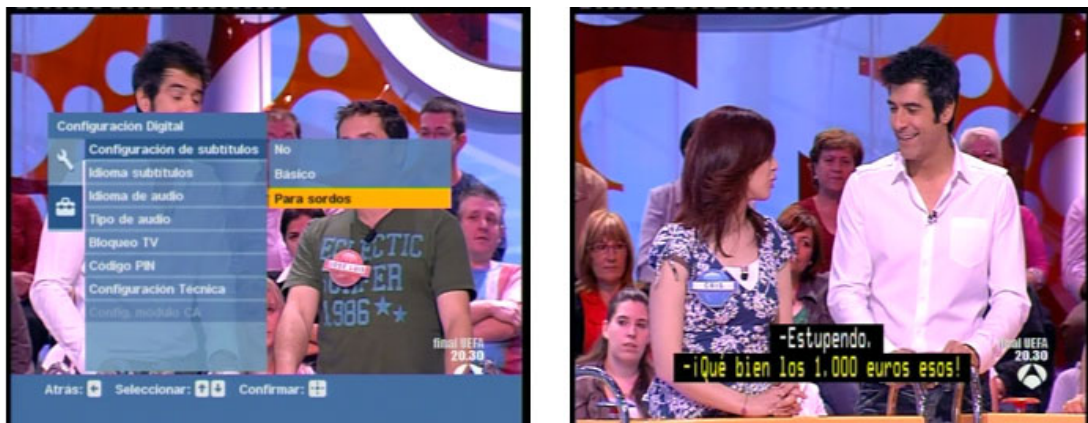
Figura 137. Menú de activación automática del subtítulo en el receptor Sony Bravia e imagen del subtítulo de teletexto.
