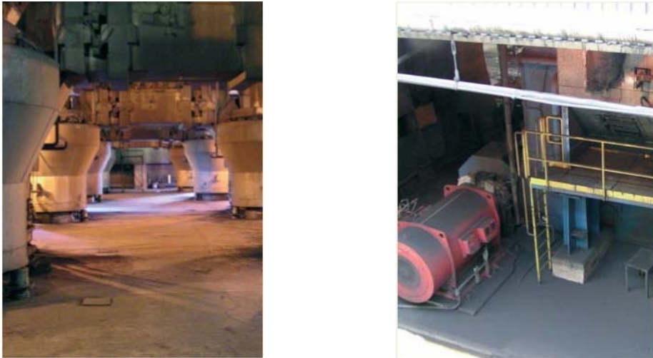
Figura 2.7 y 2.8: Separadores ciclónicos y molinos de bolas
