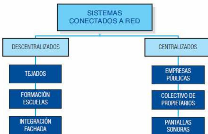
Figura 2: Esquema de aplicaciones fotovoltaicas en sistemas conectados a red
