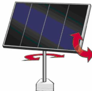
Para llevar a cabo estos seguimientos se utilizan métodos como el seguimiento por sensores, por reloj solar y por coordenadas.
