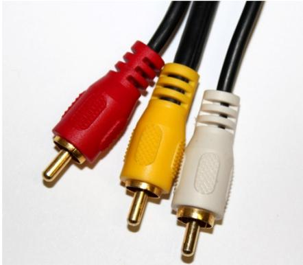
**Figura 107** Conector RCA para transmitir señal de vídeo compuesto (amarillo) y audio estéreo. (Imagen: Juan Pedro Ramos)
