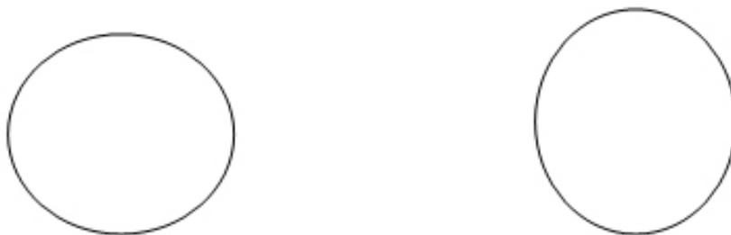
**Figura 5** Aspecto que presentaría un círculo creado con una relación de aspecto de 1:1 (ordenadores) y visualizado en una configuración de pantalla para sistema PAL (1,094:1), a la izquierda, y en una configuración de pantalla para sistema NTSC (0,9:1), a la derecha.
