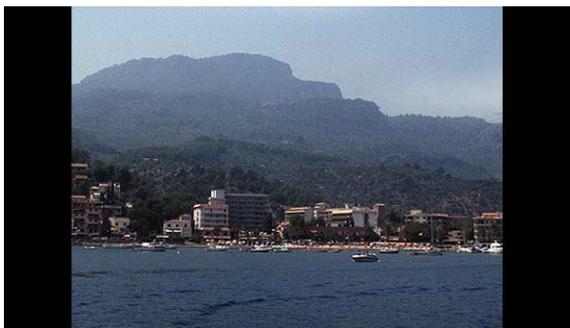
**Figura 38** Imagen 4:3 insertada en una pantalla de 16:9 (*pillarboxing*)
