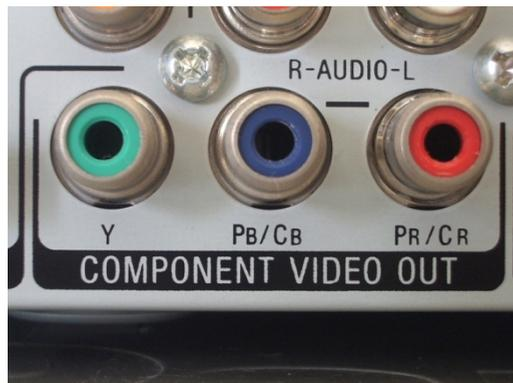
**Figura 9** Conector para señal de vídeo por componentes. (Fotografía cortesía de Juan Pedro Ramos)
