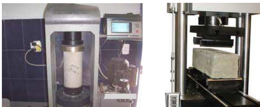
Fig. 2.6. Ensayos a compresión y flexión de probetas de hormigón
