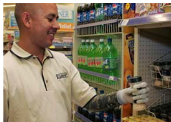
Figura 150: i-Limb de Touch Bionics es una mano biónica que aprovecha las señales mioeléctricas generadas por el propio brazo del amputado.
