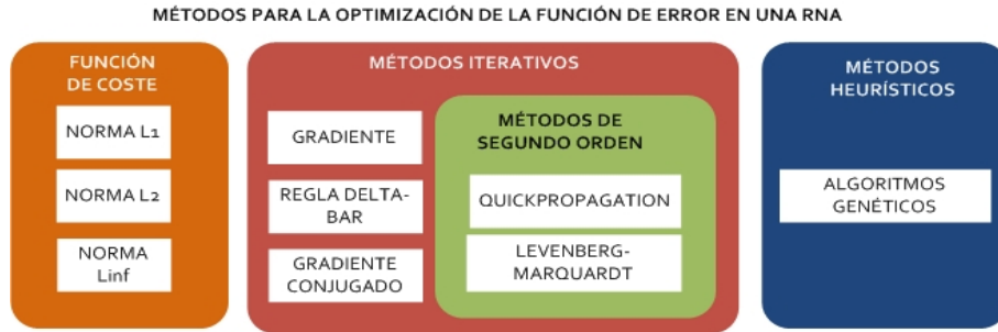
Figura 4.16: Clasificación de los diferentes métodos de optimización de la función del error utilizados
