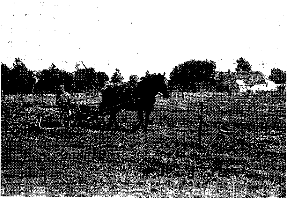
Afb. 33 Eenpaardsmaaier met opgebouwde motor.
