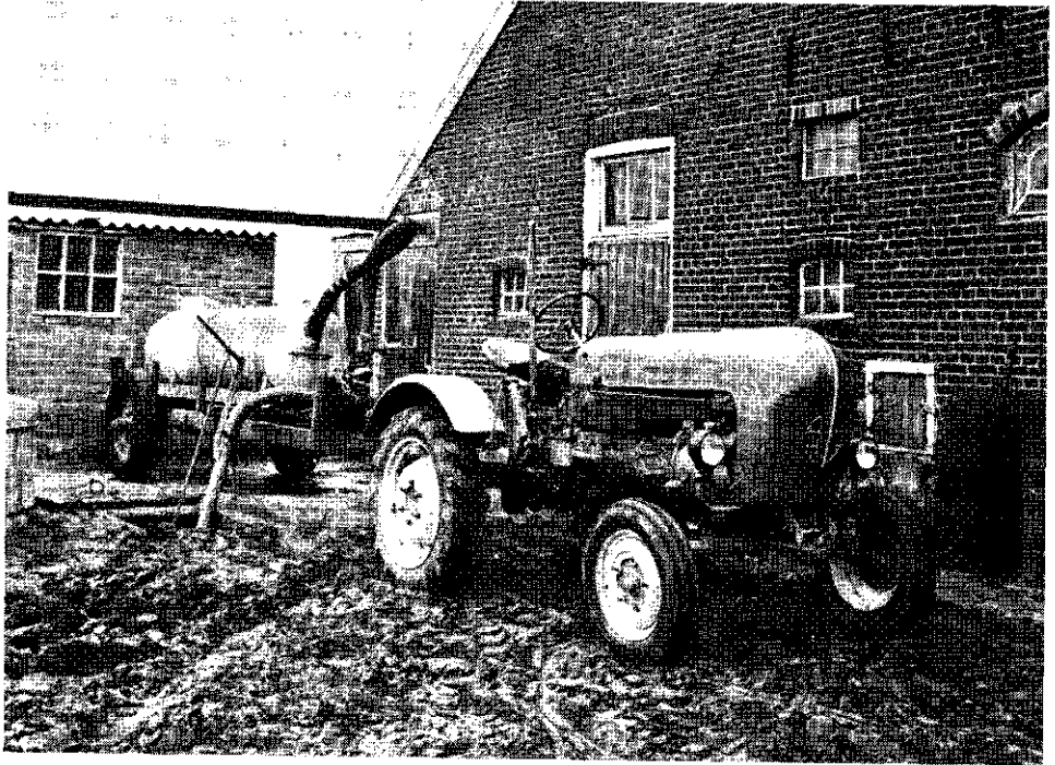
Afb. 29 Grote tank op lange wagen, gierpomp door aftakas aangedreven.
