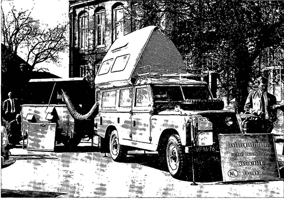
Şekil 86. Hareketli tarla laboratuvarı. Treyler bir 5 kw'lık elektrik jeneratörü, bir havalandırma cihazı, bir santrifüj ve depoyeri ihtiva etmektedir. Treyleri ve Landrover'i birbirine bağlayan tüp hava-tüpü olarak isimlendirilmektedir. Her köşede stabiliteyi artırmak için hidrolik ayaklar bulunmaktadır.
