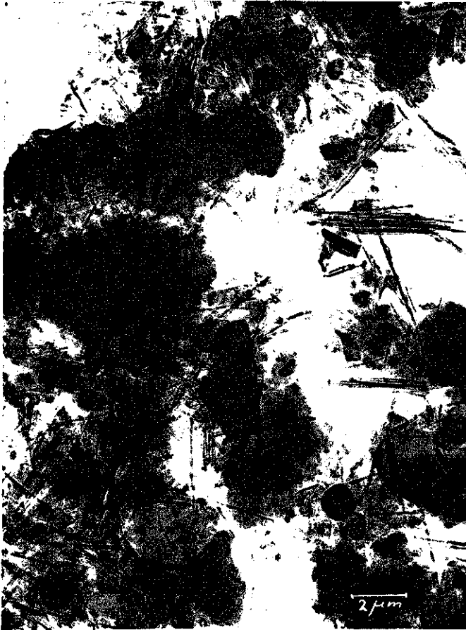
Şekil 63. Bir Marn Toprağı'nın taneleri < 2 \mu\text{m} (profil E 3.1, 105 cm) olan kireçsiz süspansiyonunun elektron mikroskop fotoğrafı. Esas kil minerali Palygorskittir (iğne şeklinde). (Fotoğraf Philips EM 300 ile TFDL tile Wageningen'de alınmıştır.)
