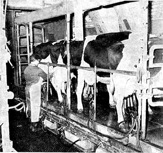
Melken in een dubbele vijfstands visgraatmelkstal. Er werd een capaciteit van 50 tot 60 koeien per man-uur bereikt. In 1971 is de melkstal met 4 standen vergroot.
