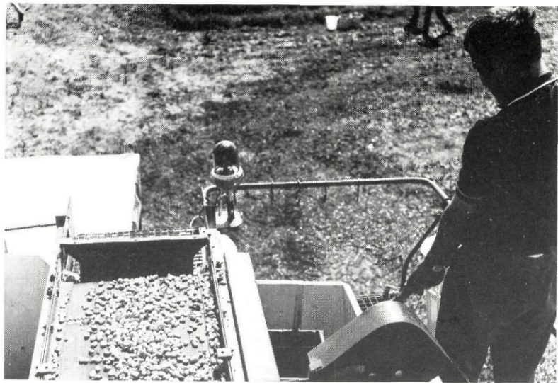
Foto 4. Met behulp van een speciale, door het ILR geconstrueerde monsterschip wordt een be- schadigingsmonster in de ver- zamelbak opgevangen.
