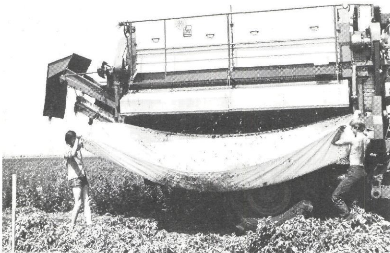
Foto 5. De tapijtverliezen worden op- gevangen over een lengte van 5 m met behulp van een linnen doek.
