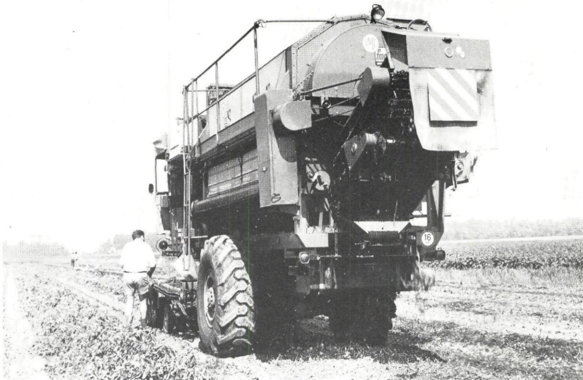
Foto 7. Het meten van de rijsnelheid op het voorwiel van de IMC-463.
