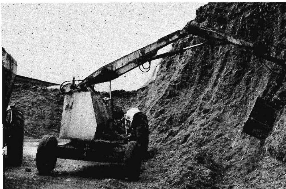
Met een gríjper wordt de ingekulde snijmals in de mengwagen gebracht (bedrijf Zambello).
