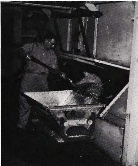
42. Deel van torendroger met geperforeerde kantelbare strokdroogvloeren (ca. 2x5 m), manipulatie-schuiven en belichtingsvensters (Top Foods).
