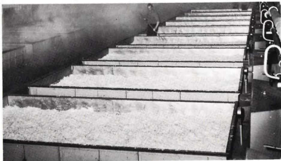
38. Open-eestdrogerij 1960 - Roestvrij metaal, mechanisering van produkttransport langs bovenrail, individuele temperatuurregeling en luchtcirculatie per eest.
