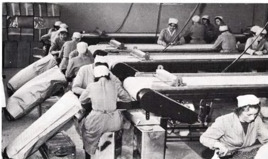
76. Handsortering en ijzerverwijdering door magneten (Top Foods).
