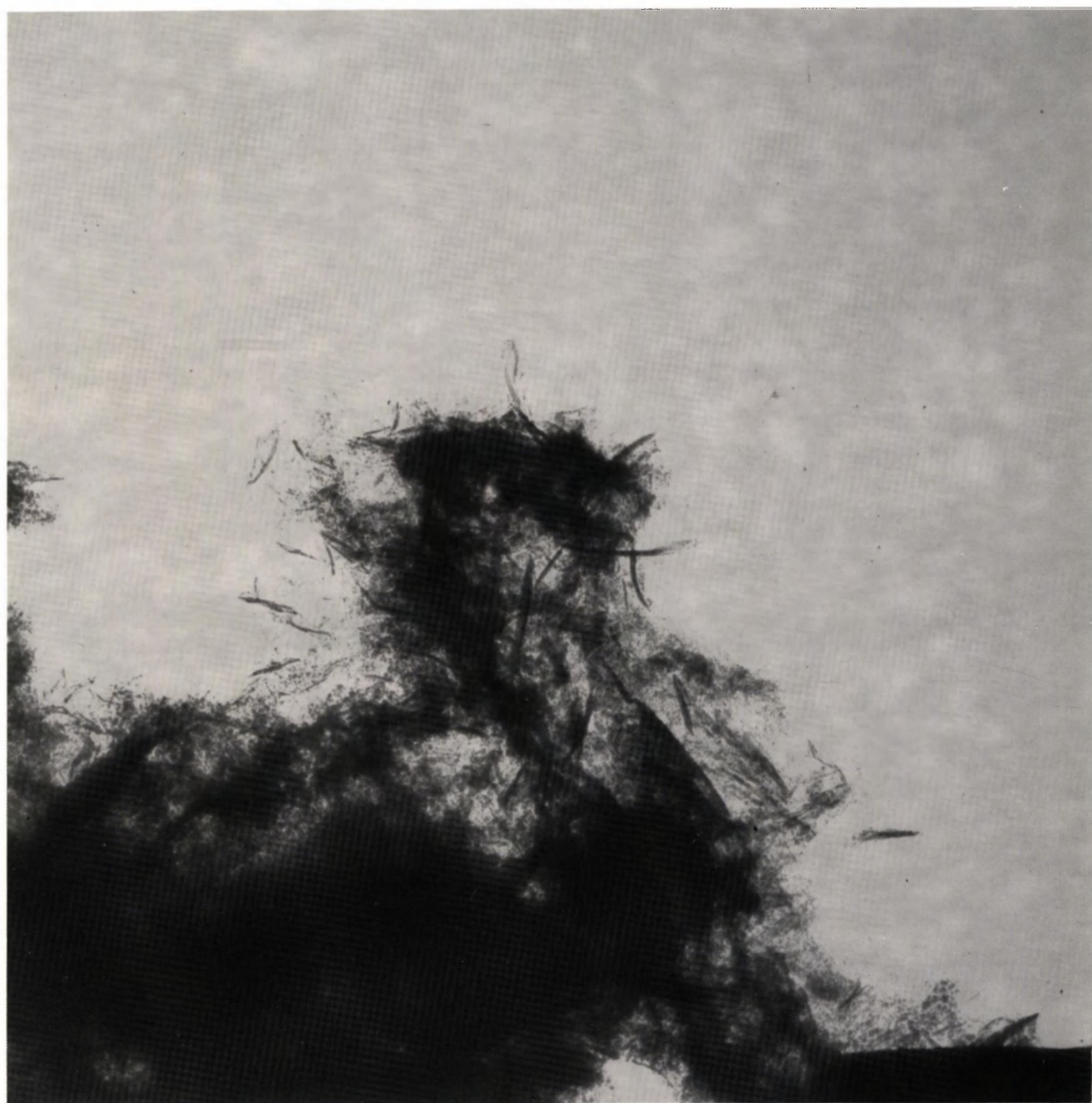
Fig. 12 TEM-opname van staaf- en draadvormig materiaal, afkomstig uit een secundair huidje. 60.500x.
