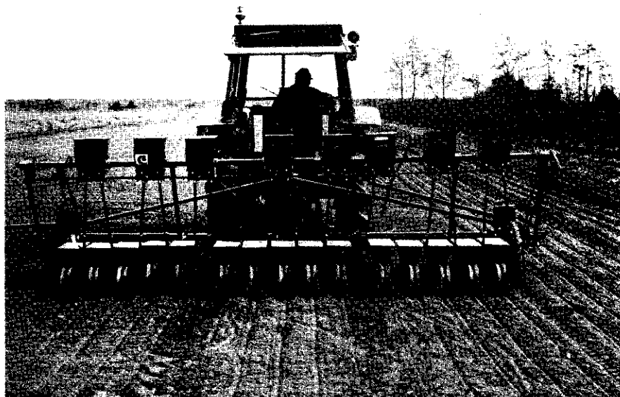
Afb. 3 Bij gebruik van een zaaimachine van 4,50 m breedte wordt bij het zaaien over de rijpaden gereden.
