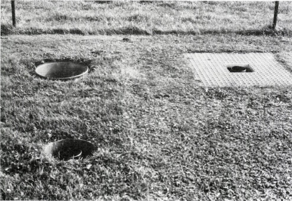
Afb. 3 - Grondregenmeters opgesteld op station Assink. Rechts de 2 dm 2 in een gedraineerde kuil (G 2) en op de voorgrond de Salland (S 2) regenmeter.
