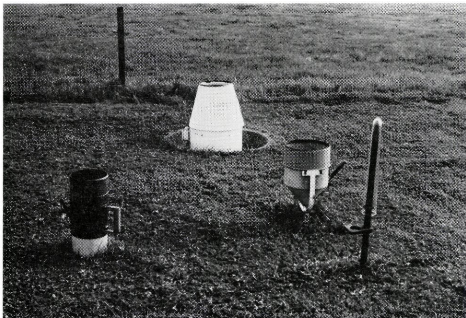
Afb. 1 - Meteostation Assink met in het midden op de foto de pluviograaf (P 4) en rechts de 4 dm 2 regenmeter (A 4). Links op de foto een 2 dm 2 regenmeter (A 2).
