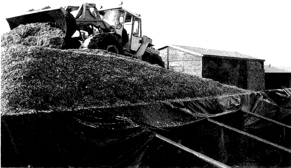
Figuur 4 Vulling van de silo met de snijmais met een wiellaadschop met gelede besturing, zwaarte 11.500 kg.
