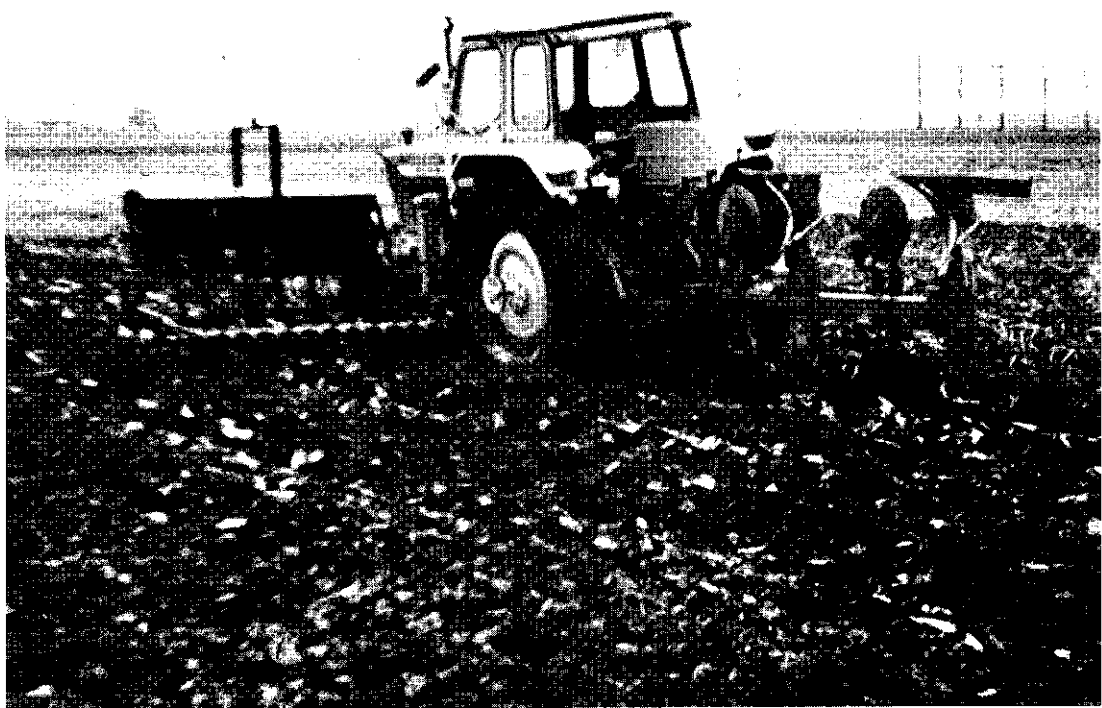
Foto 1. De ploeg-zaaimachinecombinatie, zoals die gebruikt werd voor het in-zaaien van tarwe voor object A, lossegrondsteelt.
