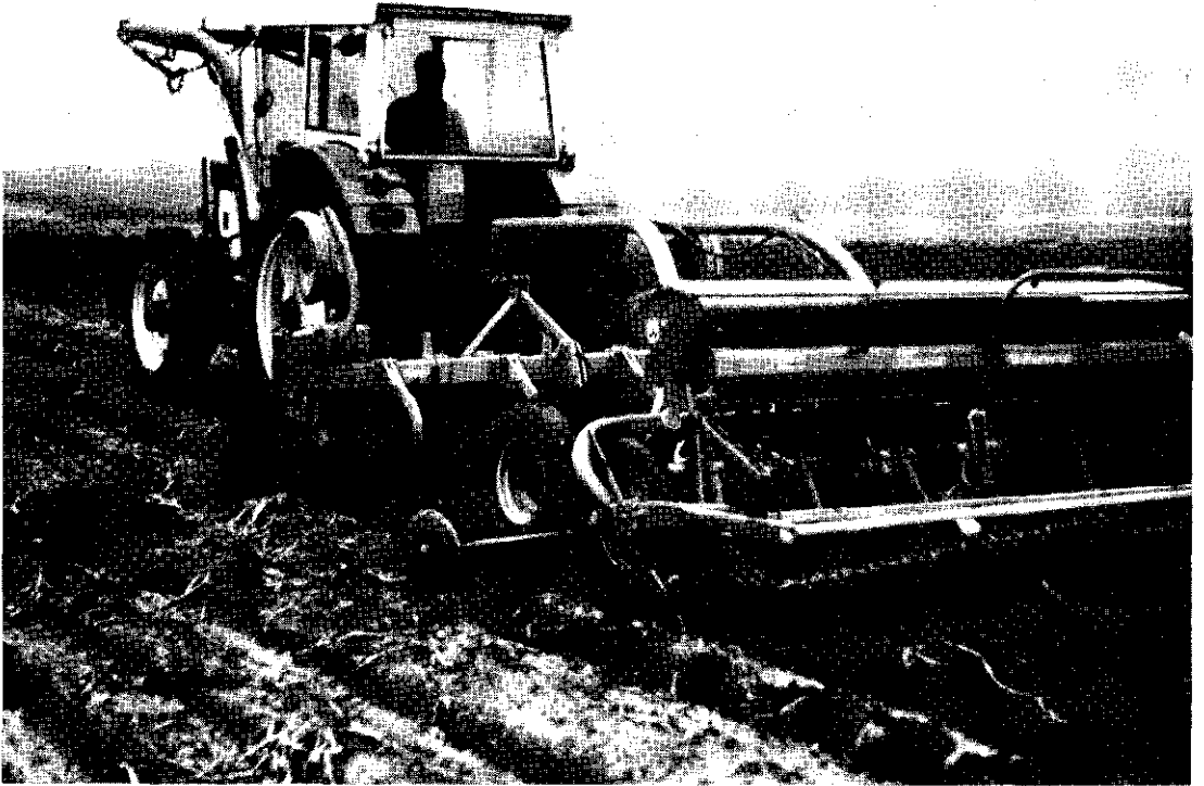
Foto 5. Bij tarwe in object C, rationele grondbewerking, werd de vastetandculti- vator gecombineerd met de zaaimachine.
