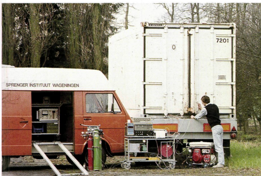
Met behulp van een mobiel meetstation worden veel gegevens verkregen over de condities in de afzetketen
