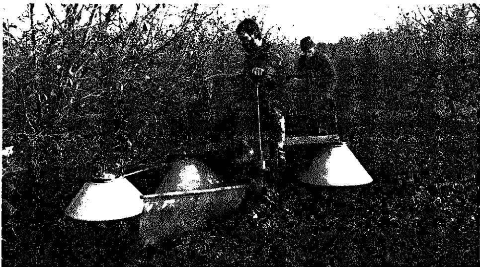
Afb. 39. Opraapmachine voor hazelnoot. De noten (en bladeren) worden op stroken geveegd en daarna opgenomen, geschoond en in fust gedeponerd. Foto welwillend ter beschikking gesteld door Ets. Cacquevel, S. A. E. Gavrav, Frankrijk.
