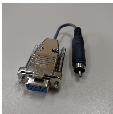
Figura A.13 – Interface serial 1-Wire desenvolvida
