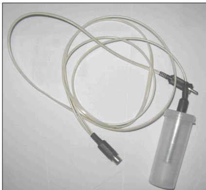
Figura A.2 – Sensor de temperatura 1-Wire DS18B20 desenvolvido para emprego submerso em líquido (água)
