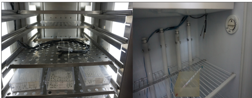
Figura A.9 – Utilização do sensor de presença de luz desenvolvido nos equipamentos do LASO
