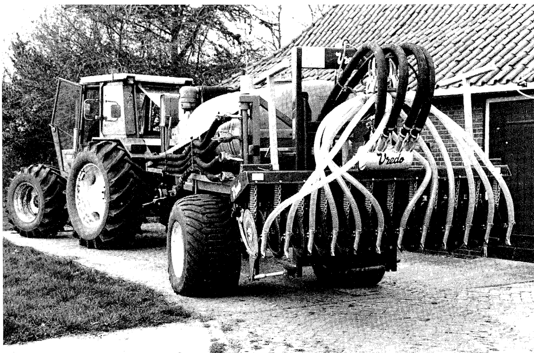
De proefveldmachine waarmee het onderzoek is uitgevoerd, uitgerust met de zodebemester.
