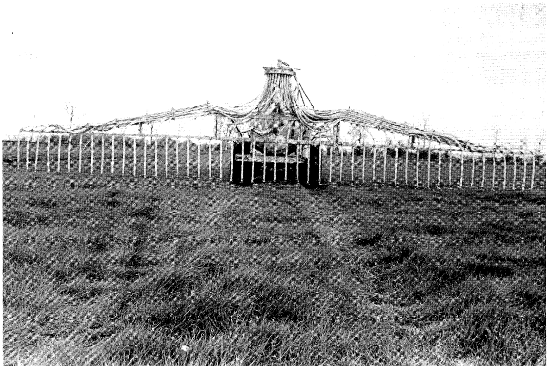
Sleepslangenmachine voor exact verdelen van aangezuurde mest.
