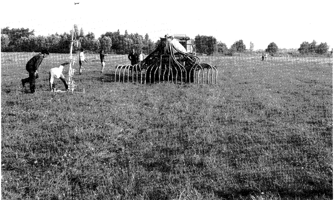
Met de masten wordt de ammoniakemissie gemeten tijdens (en enkele dagen na) het uitrijden met de sleepvoetenmachine.
