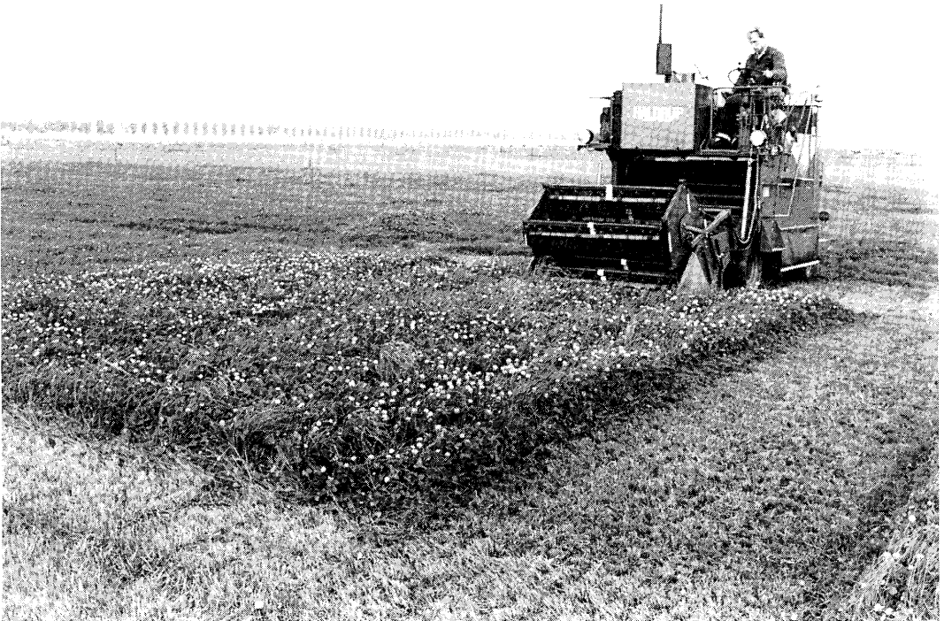
Met de Haldrup proefveldmaaimachine werden de proefveldjes in één werkgang gemaaid en gewogen.
