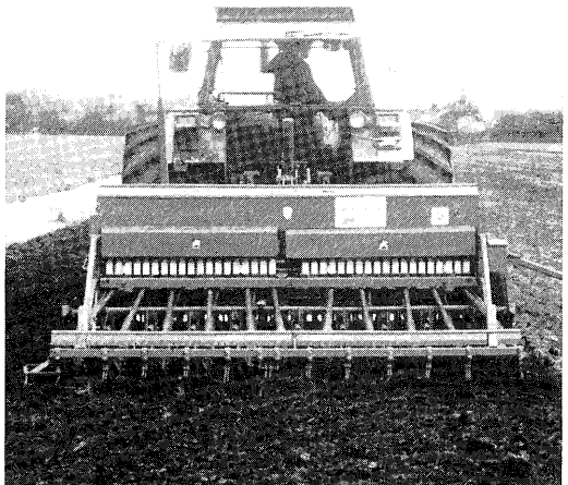
Bij een schijvenzaaimachine wordt het zaad in bredere strookjes gezaaid.
