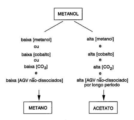
Figura 1 - O destino final de metanol em bioreatores anaeróbios
