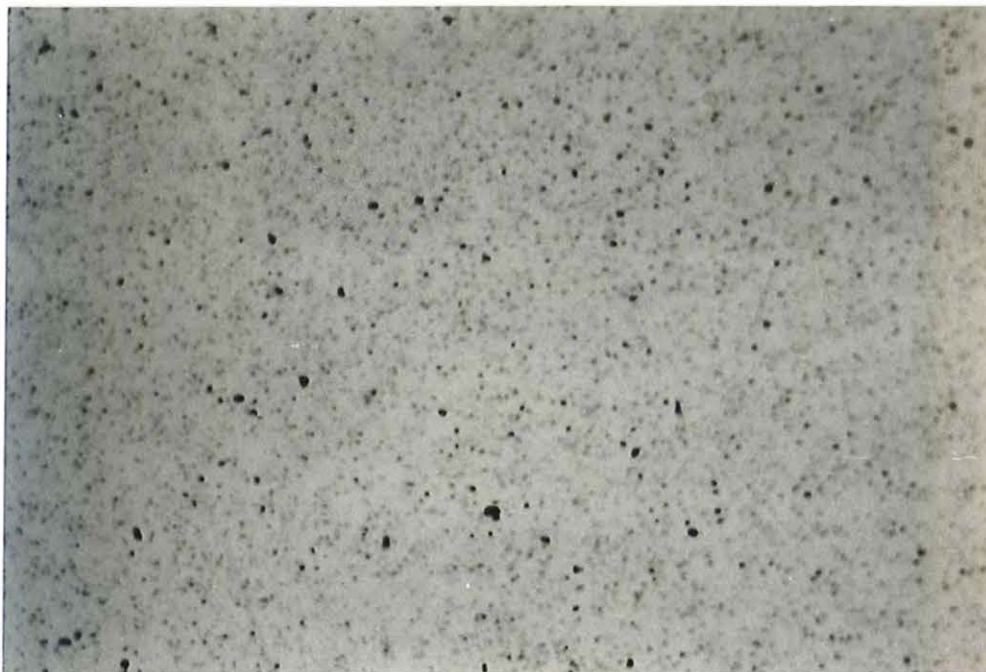
5.2 Microscopische foto van S & S 1450 poriëngrootte 18 \mu\text{m} zwarte stippen zijn noritdeeltjes < 105 \mu\text{m}
