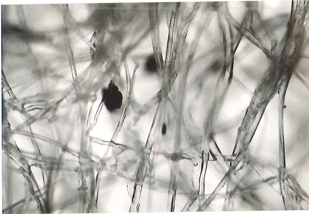
5.1 Microscopische foto van een boerderijfilterkous poriëngrootte circa 80 \mu\text{m} zwarte stippen zijn noritdeeltjes
