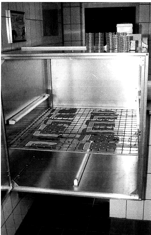
Foto 2: Proefopstelling met te behandelen voorwerpen (vezelstof) in de UV-C-kast
