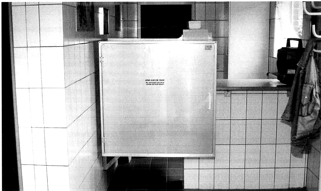
Foto 1: Kast waarin materiaal wordt gedesinfecteerd door blootstelling aan UV-C
