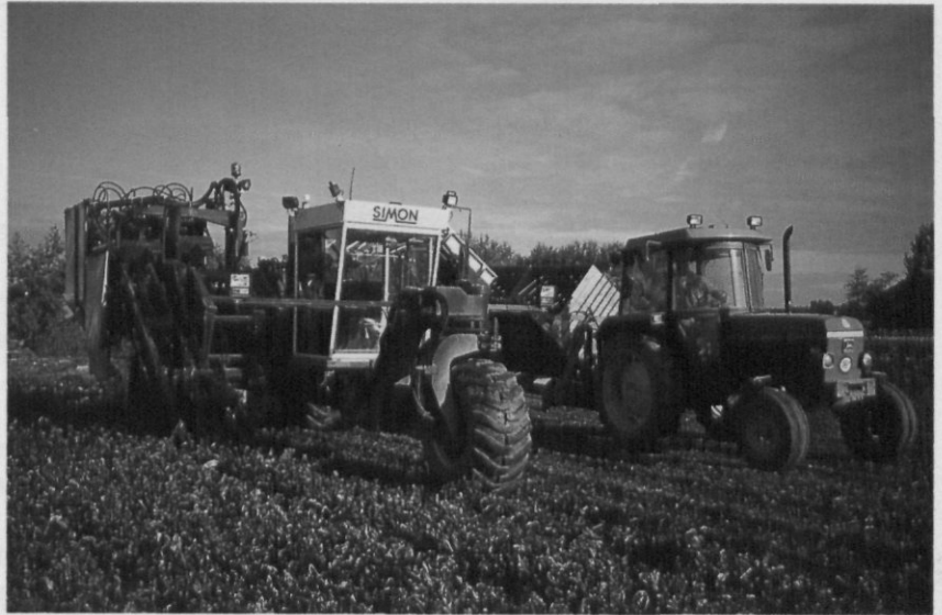
Afbeelding 18. Machinale oogst van kroten met klemband- rooier.
