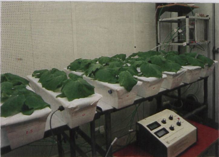
Foto 3 On-line controle van de zuurstofconcentratie van de begassingslucht met behulp van een zuurstofelektrode.
