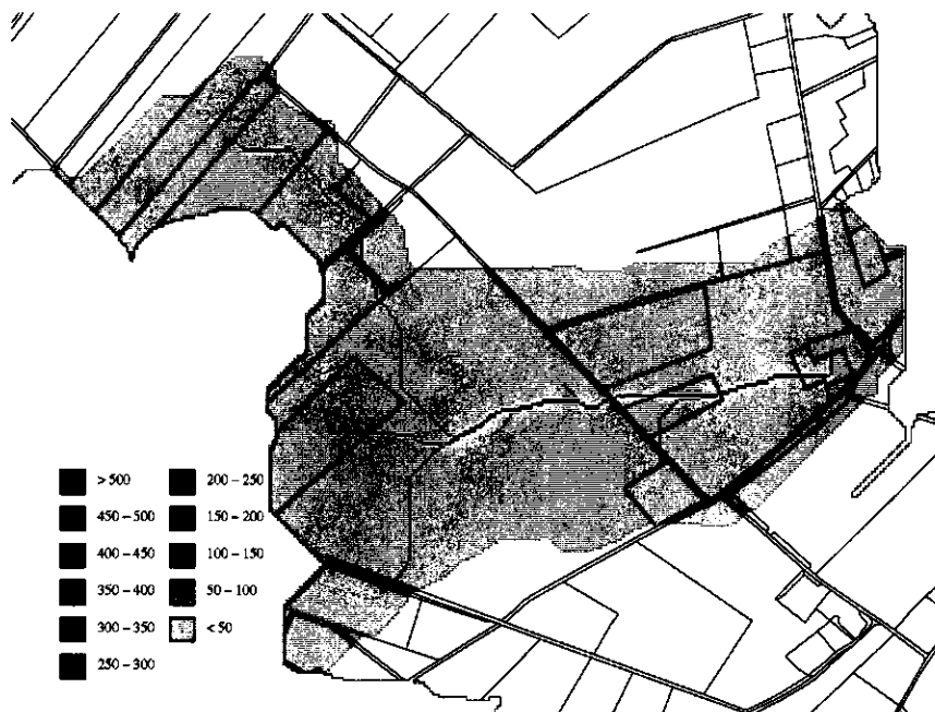
Fig. 21 Afvoerpatroon van water in stroomgebied 2 na 50 minuten van een winterbui met een herhalingsperiode van 25 jaar bij huidig grondgebruik (afvoer in l/s).
