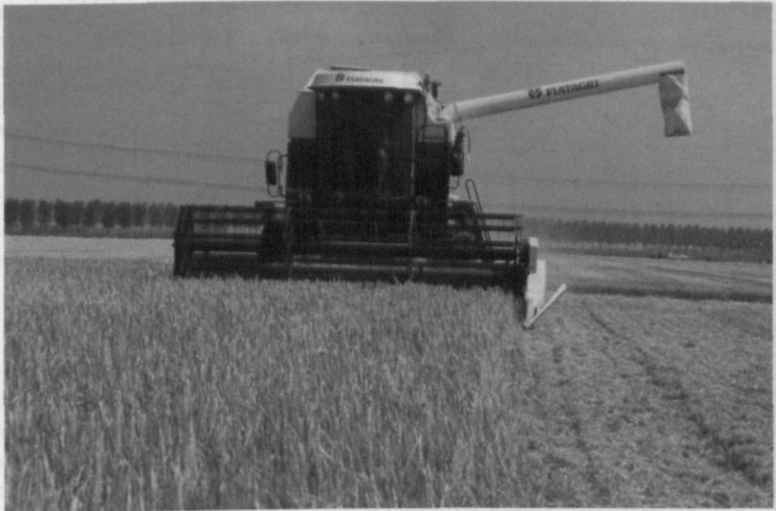
Afbeelding 14. Het afstellen van de maaidorser is van groot belang voor de kwaliteit van het eindproduct.
