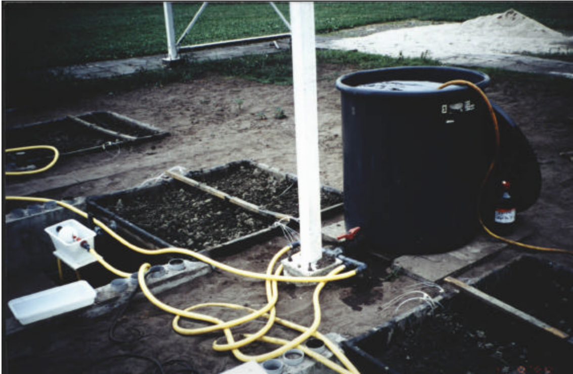
Foto 2 de gevulde bakken en het wateraanvoersysteem
