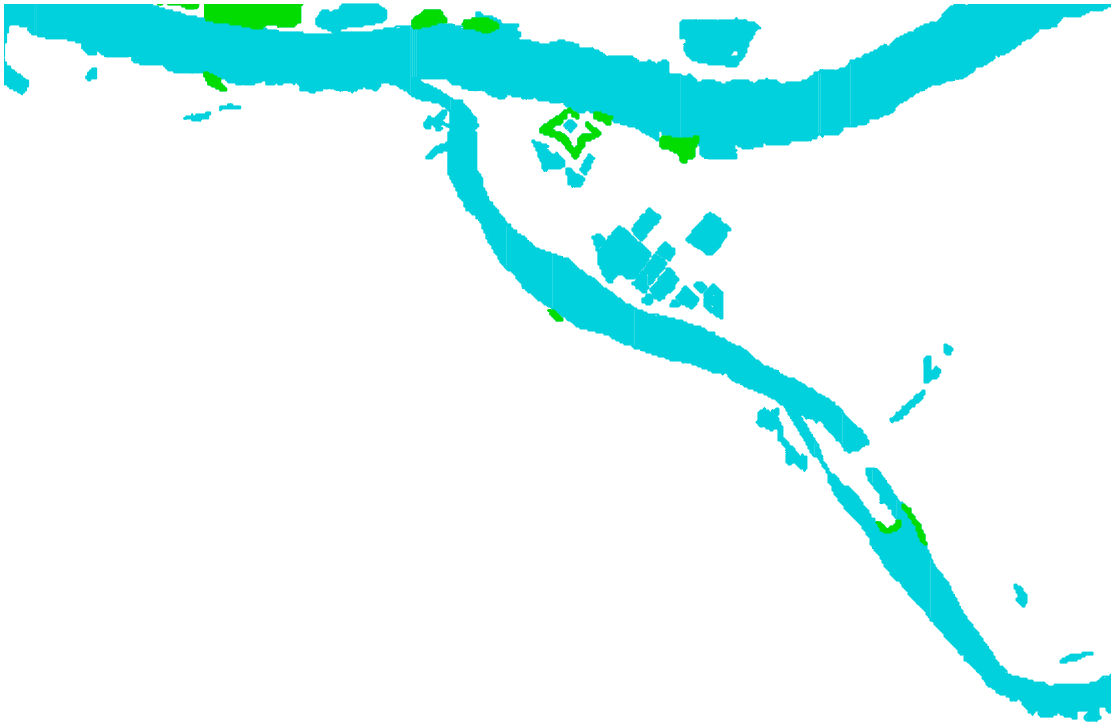
Figuur 3.17 Smalle stuk (Wilhelminasluis) in de Afgedamde Maas zorgt ervoor dat er een fout in de analyse op treedt. De twee zwak duurzame netwerken zouden aan elkaar gekoppeld moeten worden. Dit ene netwerk zou ook zwak duurzaam zijn geworden.
