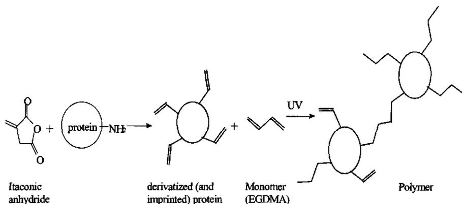
**FIG. 5.1. DERIVATIZATION AND POLYMERIZATION OF EPOXIDE HYDROLASE (EH)**
