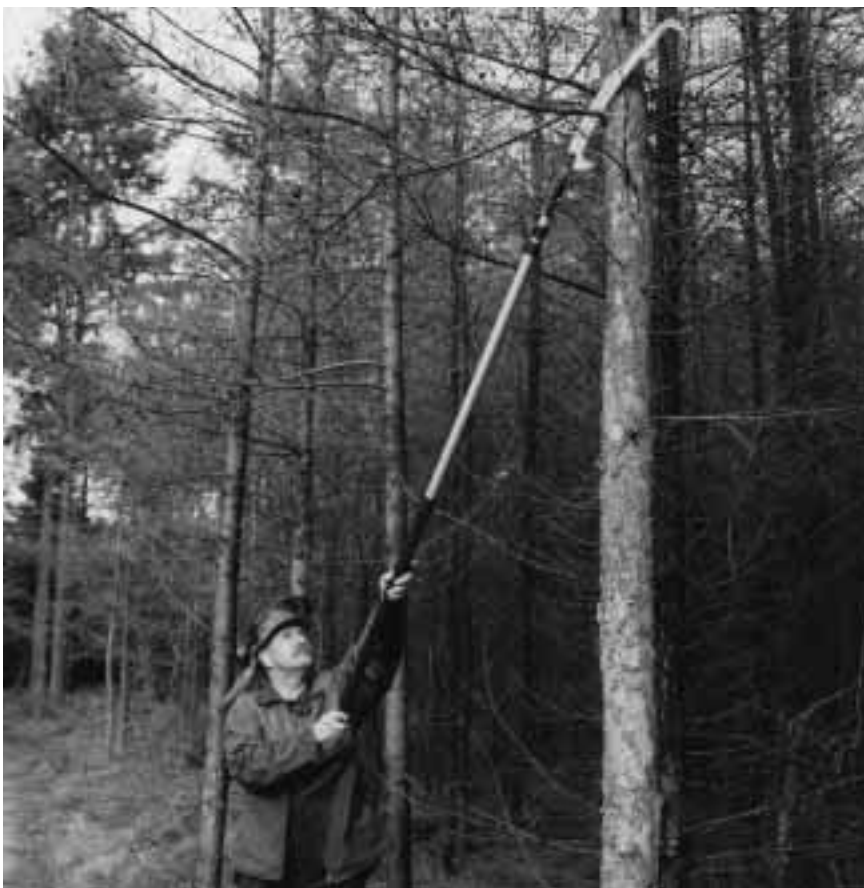
In Nederland wordt momenteel vooral de handzaag gebruikt tot 2,5 meter en de stokzaag tot maximaal 6,5 meter. Foto: Stichting Bos en Hout.
