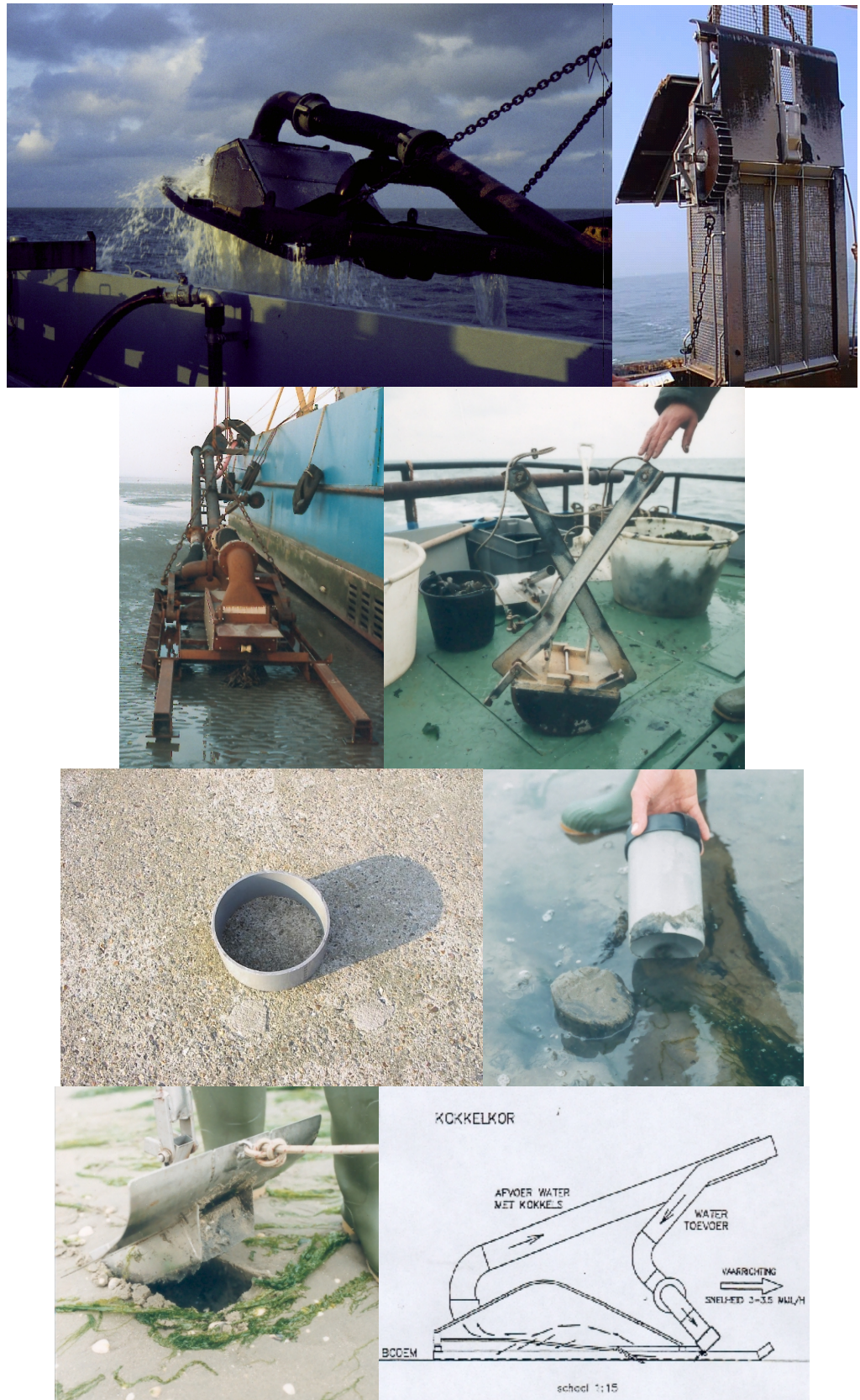
Figuur 3. Overzicht van monstertuigen gebruikt door het RIVO (van links naar rechts / boven naar beneden): zuigkor, guts, stempelkor, bodemhapper, steekring, steekbuis, kokkelschuijfe, schema zuigkor.
