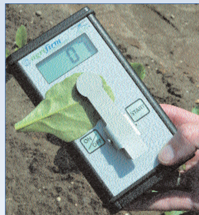
Met dit draagbare meetapparaat kan kort na de bespuiting via fotosynthesemeting worden vastgesteld in hoeverre de bespuiting effectief is geweest.
